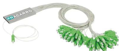
**Partitore ottico PLC miniaturizzato a 64 vie** adatto alla realizzazione dei ROE di edificio, con tecnologia planar waveguide che consente **bassissime perdite d'inserzione**. Adatto per una distribuzione ottica a basso costo ed a alte prestazioni, si presta all'utilizzo in innumerevoli tipologie installative.
